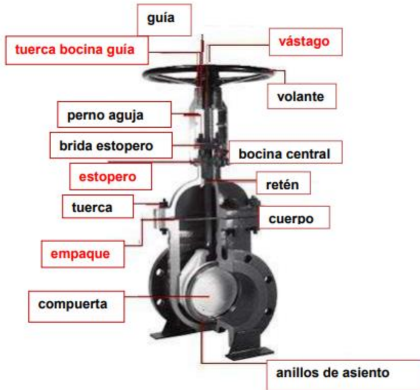
Figura 8. Partes de una válvula y puntos de falla típicos.
