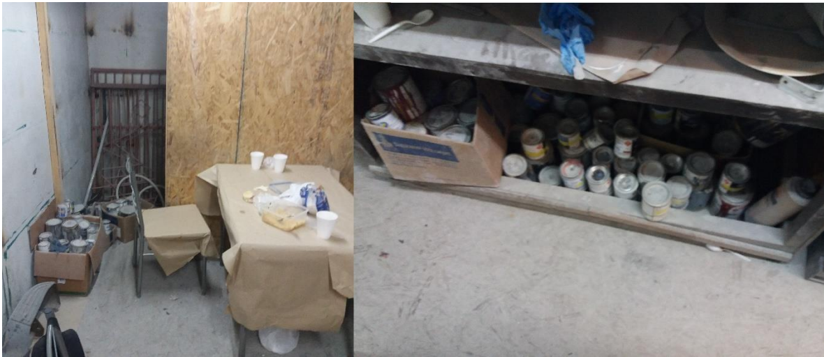
Figura 71. Taller Desabolladura y Pintura que almacenaba residuos junto con lugar de almuerzo y descanso de trabajadores.
