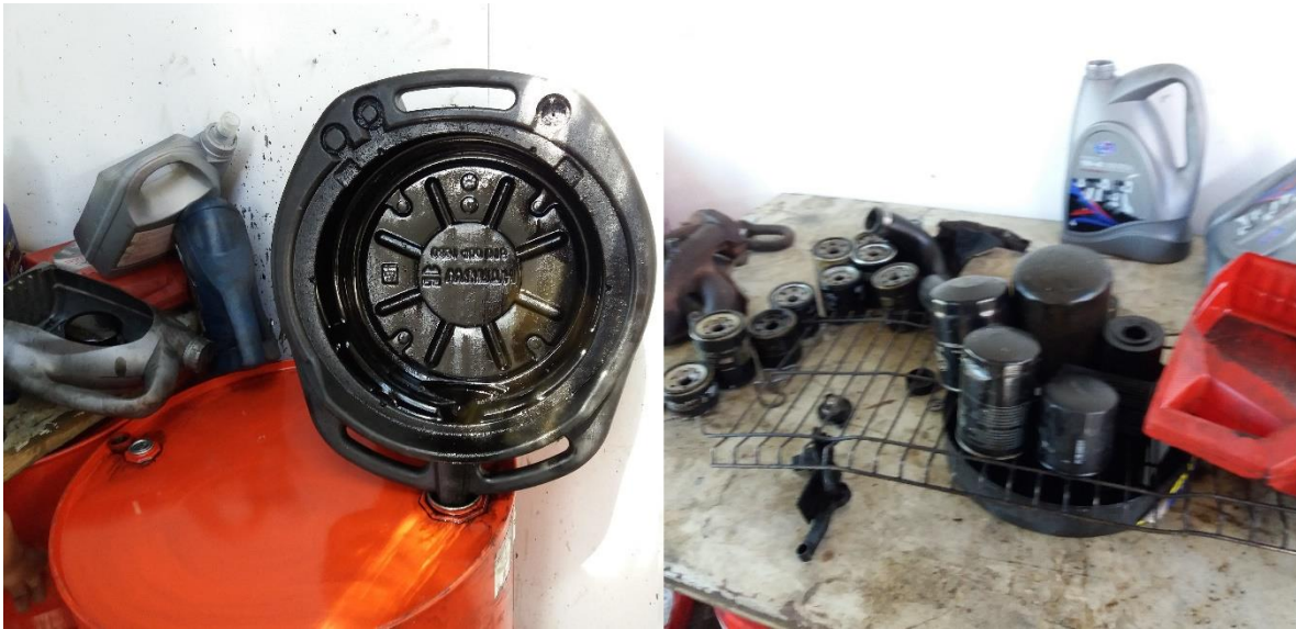
Figura 65. Manejo inadecuado de residuos resultantes del cambio de aceite lubricante 2. Fuente: propia
