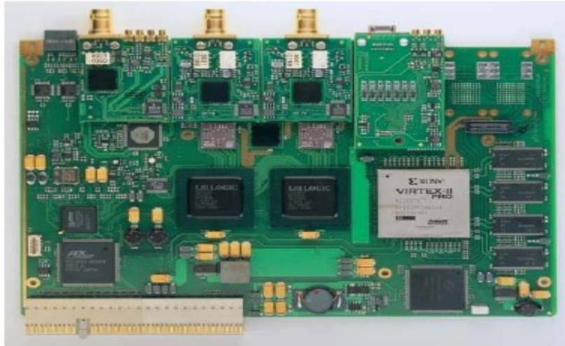
Figura 6: Tarjeta digitalizadora AC240. En la parte alta se muestran las dos entradas analógicas para la señal IF en rangos de 0-1[GHz], además de una entrada para el reloj y la interfaz de control del sistema. En la parte inferior se muestra el PCIbus para la salida de los datos. A la derecha se puede ver la FPGA XILINX VirtexII Pro70. (Fuente: Bernd Klein (2007). “CSO-FFTS A fast fourier transform spectrometer for the CSO”[8].)
