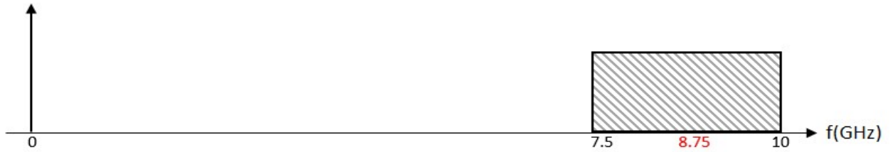
Figura 33: Señal pasa banda con frecuencia carrier de 8.75[GHz] y ancho de banda B de 2.5[GHz]
