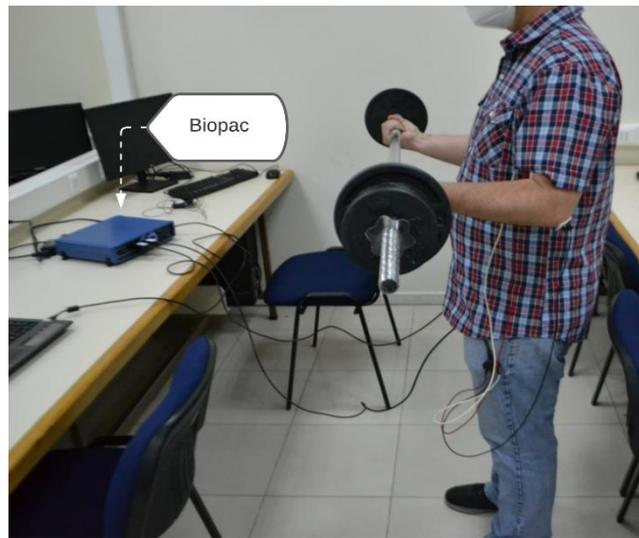
**Fig. 3.2** Adquisición de señales en laboratorio utilizando equipo Biopac.
