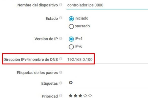
Figura 13: Configuración de nuevo dispositivo en PRTG.
