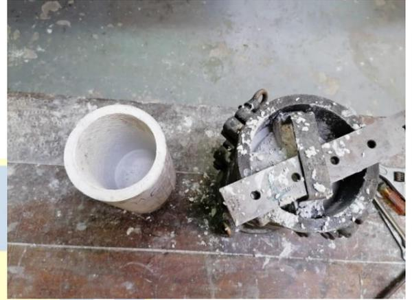
*Figura 14: (a) vista frontal del molde (derecha) y del crisol (izquierda), (b) vista superior de (a)*
