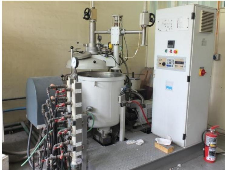
Figura 15. Horno de inducción de alto vacío VOGELE APPARATEBAU
