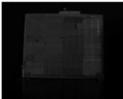
*Figura 3.16 Imagen tomada con 0.5[A] y 20.9[V].*
