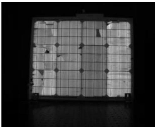
*Figura 3.35: Imagen tomada con 2.4[A] y 23.8[V].*
