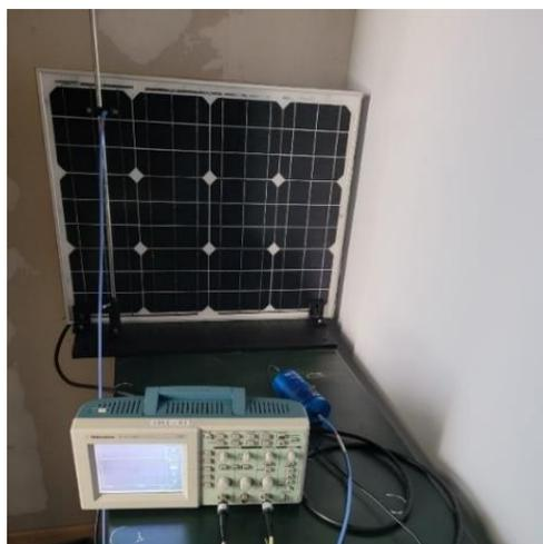
*Figura 3.6: Set-up medición de salida de voltaje por celda, panel 1.*
