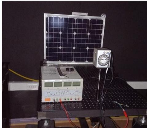
*Figura 3.10: Set-up tomas fotográficas de electroluminiscencia al panel 1.*
