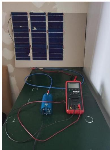
*Figura 3.46: Set up medición de salidas de voltaje del panel 2.*
