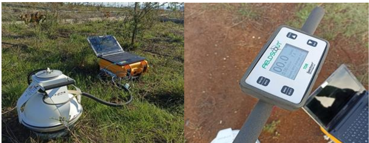
Figura 5. (a) muestreo del flujo de CO 2 con el equipo LICOR acoplado al tubo previamente instalado. (b) medición de la temperatura y humedad del suelo.
