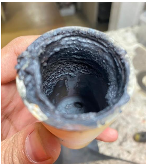
Figura 19: Crisol con pérdidas de material en las paredes a caudales altos de espumación.
