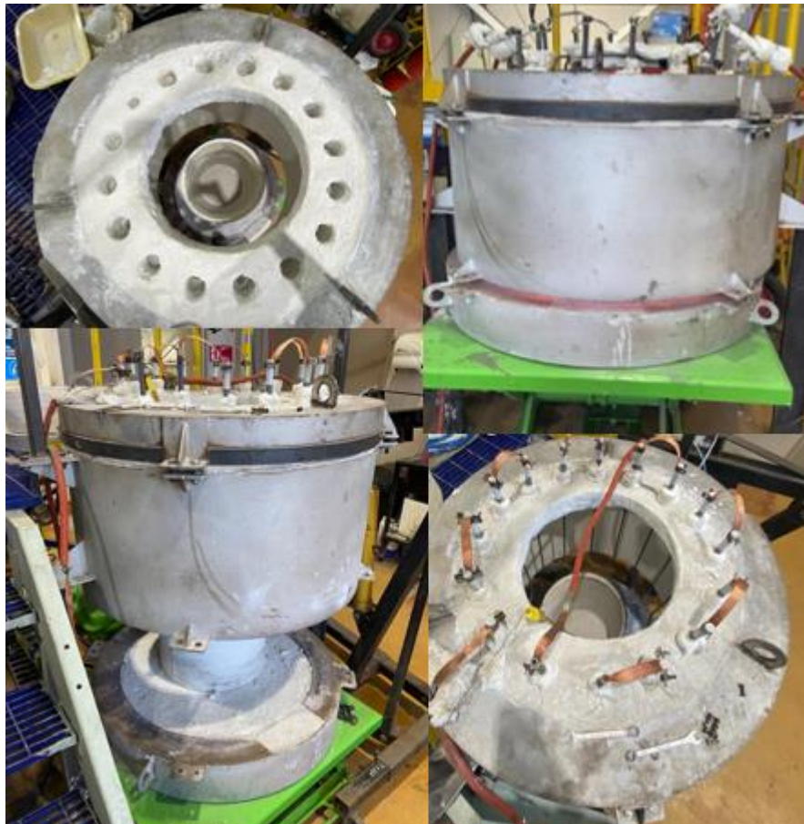
Figura 14: Reparación y puesta en marcha de horno CODELCO TECH
