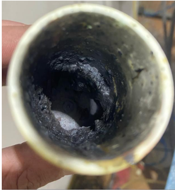
Figura 21: Formación de fase sobresaturada con pérdidas de material en las paredes del crisol
