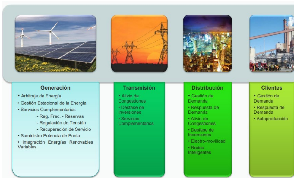
Figura 4.2 Aplicaciones de los Sistemas de Almacenamiento de Energía CNE [39]
