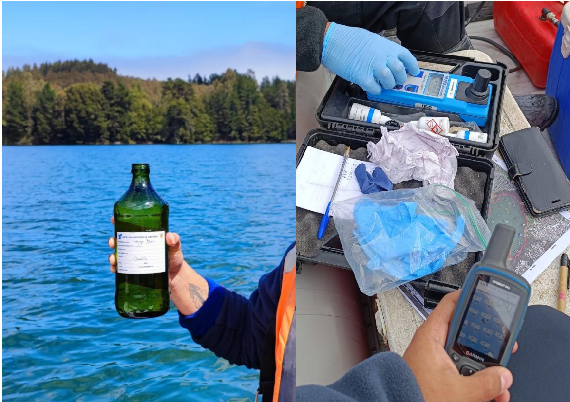
Figura 2. Equipo utilizado en campo para la toma de muestras de agua. A la izquierda se ve un ejemplo de las botellas utilizadas, mientras que en la derecha se ve un turbidímetro de campo en la parte superior y un GPS en la parte inferior.
