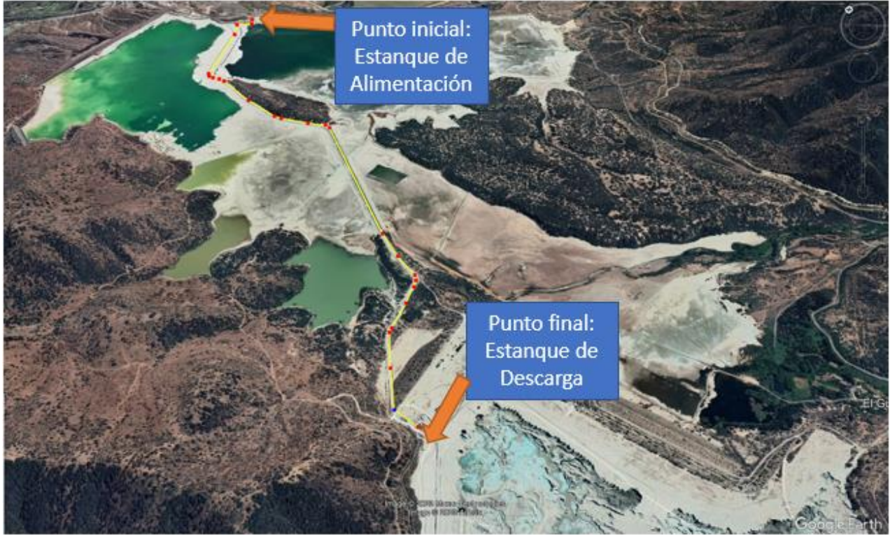
Figura 1.1: Ruta del sistema de impulsión.
