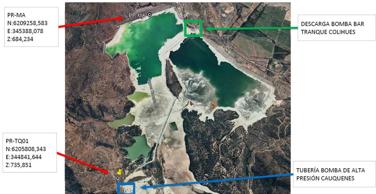
Figura 3.5: Levantamiento topográfico del sistema de impulsión. Fuente: [3].
