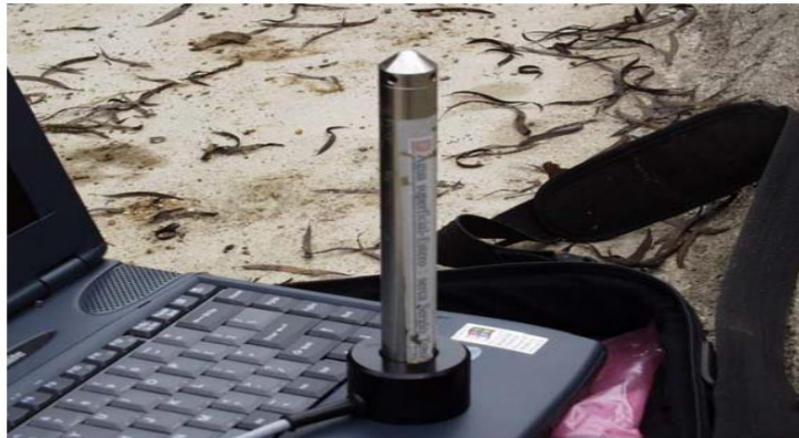
Figura 6. Sensor de presión conectado a un computador para extraer la información. Fuente: Uribe et al. , 2004.
