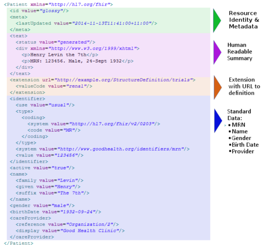
Figura 5: Estructura de un recurso de tipo Patient en formato XML, obtenido de [7]
