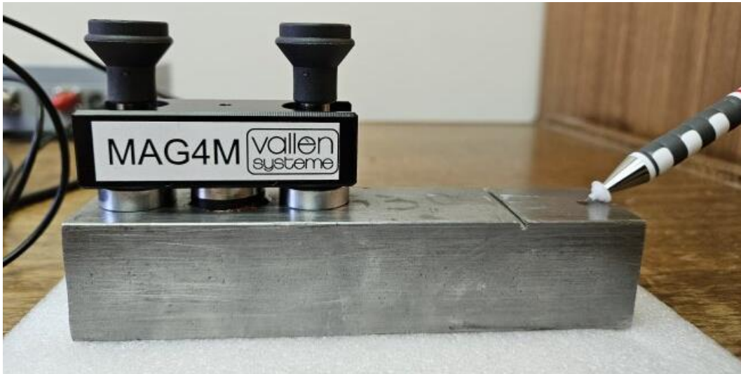
Figura 19. Ensayo Hsu Nielsen para determinar la influencia de la falla.
