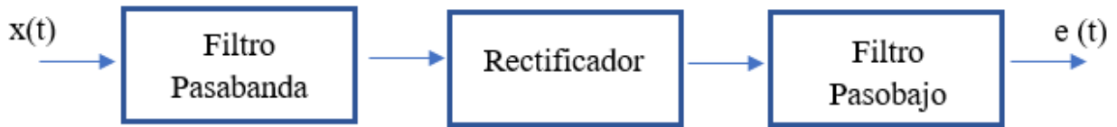
Figura 16. Esquema del proceso de rectificado y filtro paso bajo para obtener la envolvente a la transiente.
