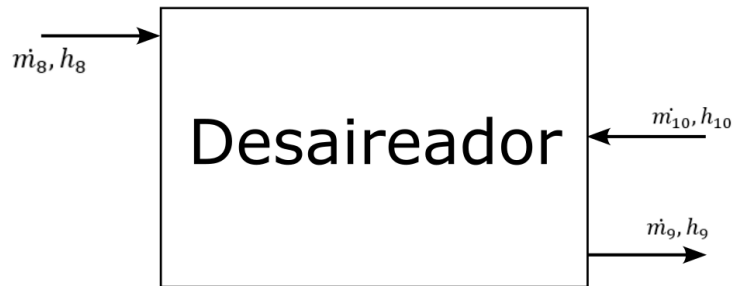
Figura 2.20: Volumen de Control Desaireador
