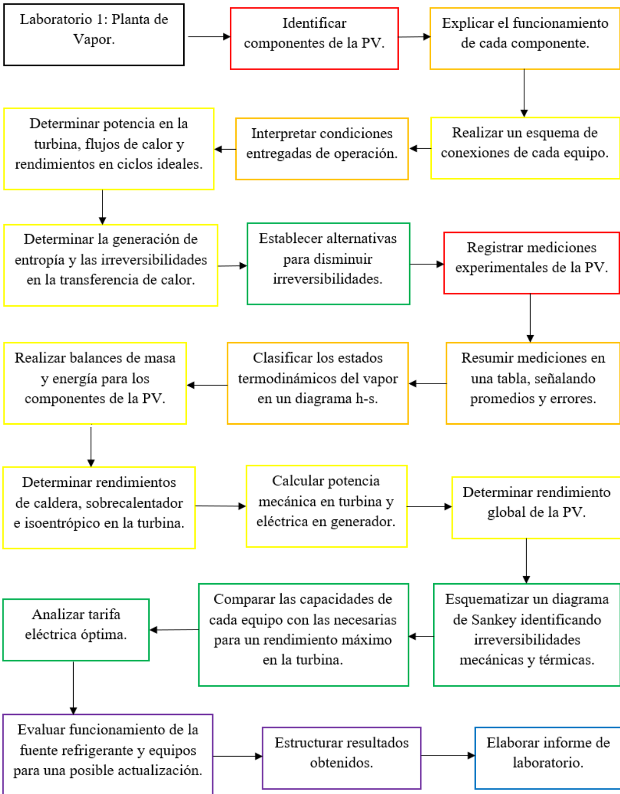
Figura 5.6: Protocolo de Ensayo Centrales de Energía, Lab. 1
