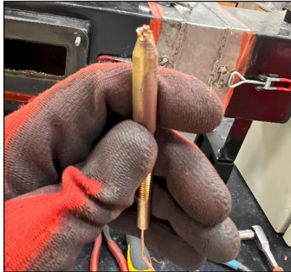
Figura 61: Boquilla con desgaste producto de chispas soldadas y su posterior limpieza.
