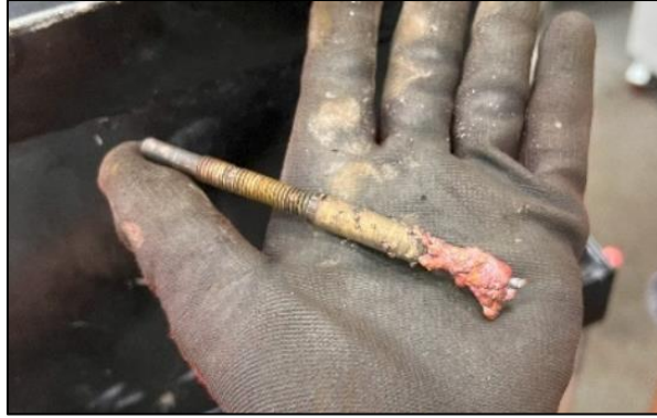
Figura 60: Boquilla obstruida por chispas de cobre soldadas.
