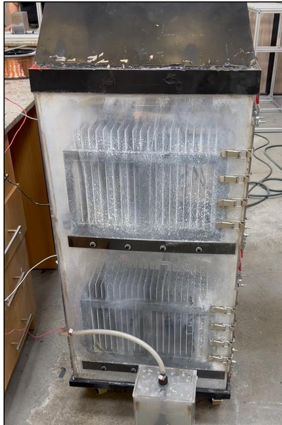
Figura 41: Cámara de recolección con nanopartículas de aluminio en suspensión.
