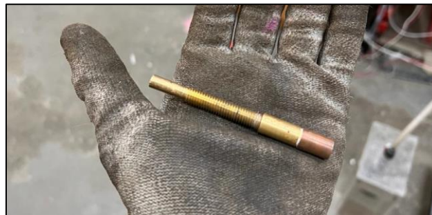
Figura 62: Boquilla con protector en su extremo.
