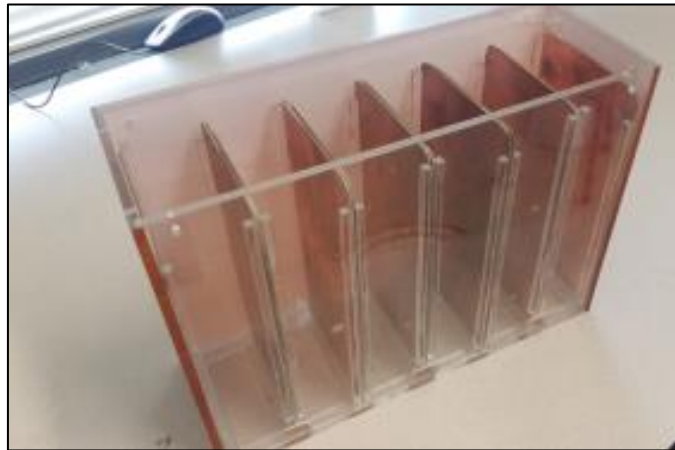
Figura 9: Cámara de aire ensamblada en prototipo con placas planas (Fuente: [24]).
