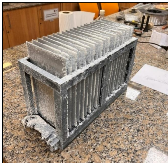
Figura 39: Set de placas con nanopartículas de zinc.
