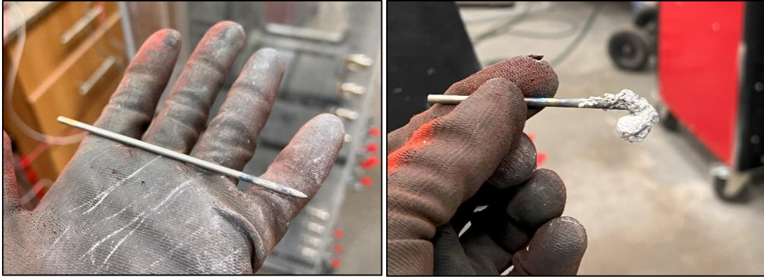
Figura 65: Comparativa de tungsteno original contra el tungsteno con acumulación de material.
