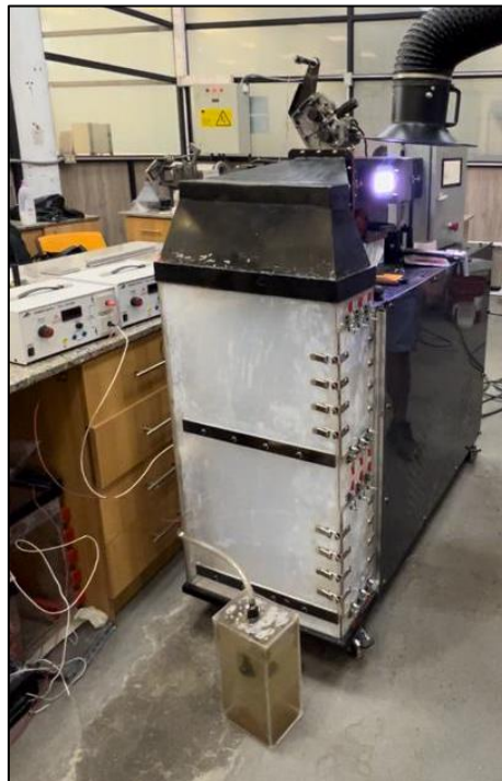
Figura 34: Prueba de hermeticidad de la cámara de recolección.
