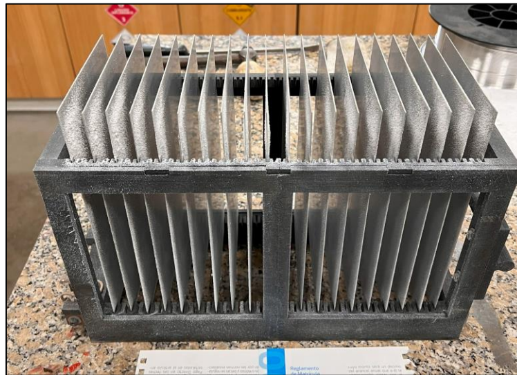
Figura F.2: Foto lateral del set de placas con nanopartículas de aluminio.
