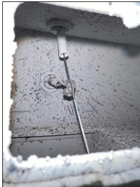
Figura 64: Tungsteno con material pegado a alta temperatura.
