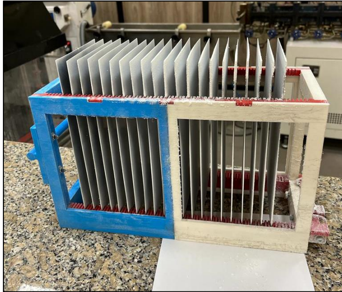
Figura 29: Set de placas con nanopartículas de zinc adheridas a las placas.
