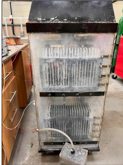
Figura 38: Cámara de recolección con nanopartículas de zinc en suspensión.
