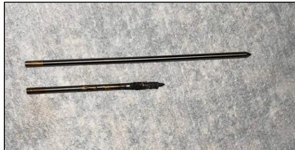
Figura 66: Comparación de tungsteno original contra el tungsteno desgastado.
