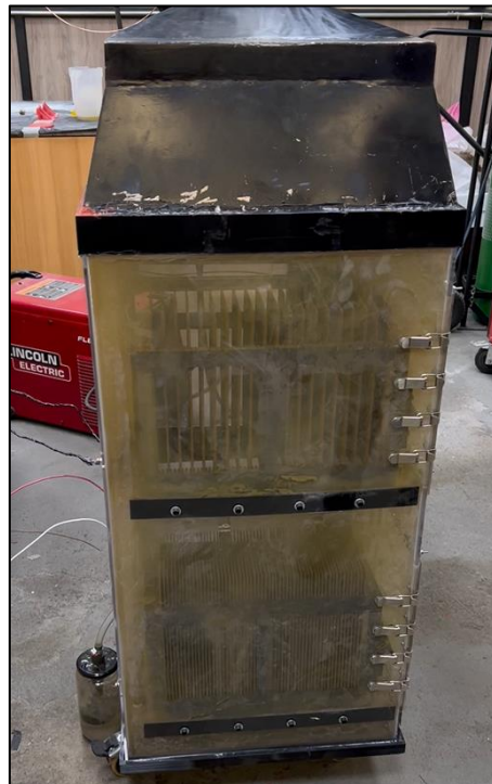
Figura 35: Cámara de recolección con nanopartículas de cobre en suspensión.
