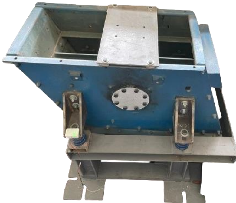
Figura 7: Medición en el apoyo izquierdo del harnero. (Fuente: Elaboración propia)
