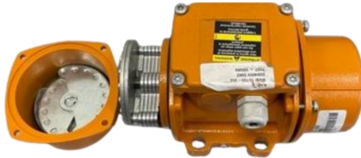
Figura 16: Motor con el sistema de masas desbalanceadas. (Fuente: Elaboración propia)
