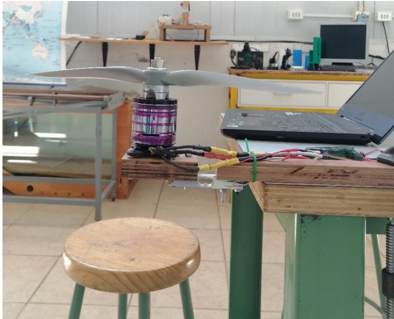
Figura anexo 2: Banco de ensayo para la medición de empuje.
