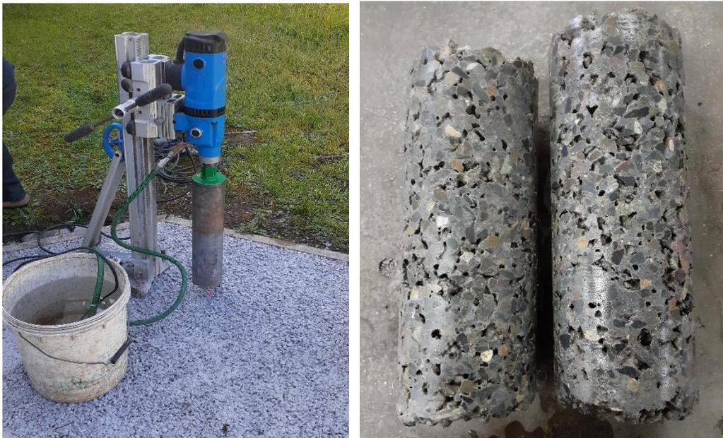
**Figura 3.7. a) Extracción de testigos, b) Testigos obtenidos de sección de prueba**
