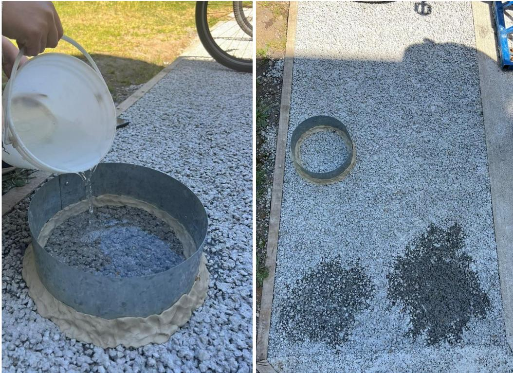
**Figura 3.11. Medición de tasa de infiltración en sección de prueba**
