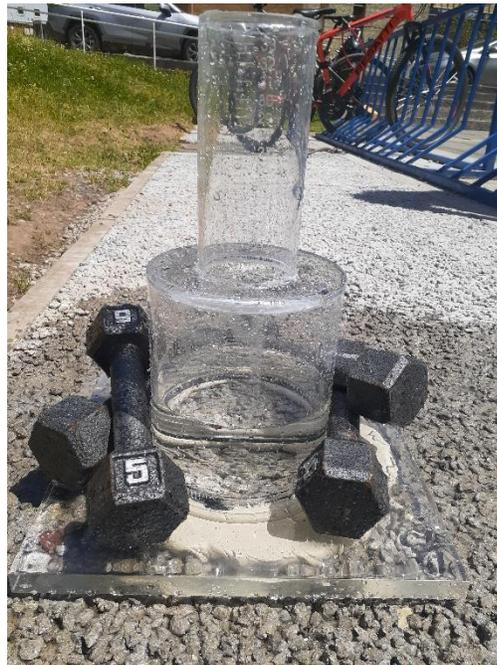
**Figura 3.9. Medición de permeabilidad mediante el permeámetro NCAT**
