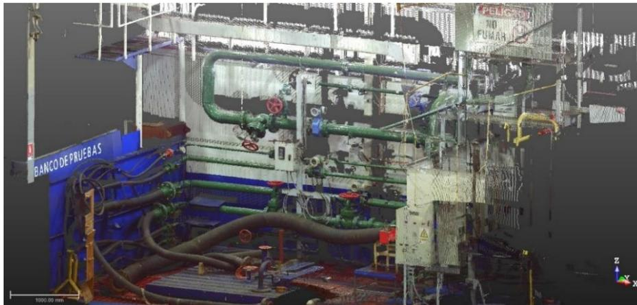
**Figura 3.1** Captura de nube de puntos del banco de pruebas desde Trimble RealWorks Viewer (Fuente: Departamento Ingeniería Naval ASMAR (T)).
