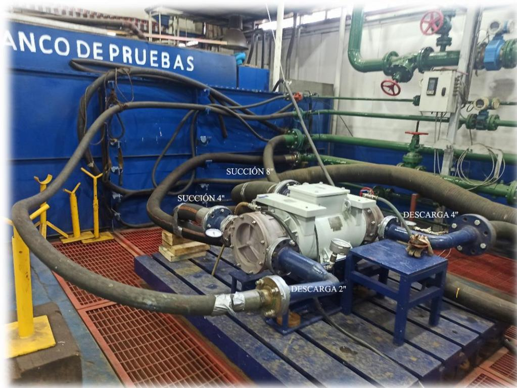
**Figura 4.8** Fotografía de bomba de dos impulsores montada en banco de pruebas (Fuente: Fotografía propia).
