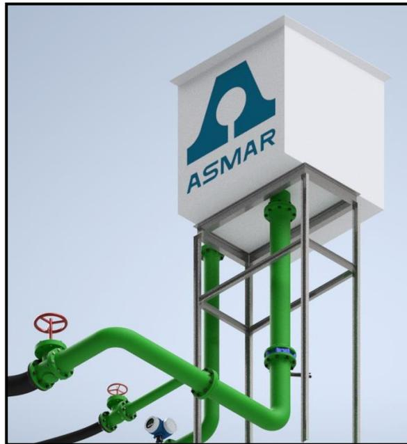
**Figura 5.1** Vista de Conexión de Líneas de Succión con Estanque (Fuente: Renderización Propia).
