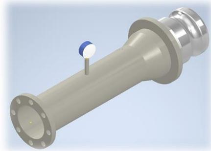
**Figura 4.3** VS2; Carrete brida a acoplamiento rápido según norma (Fuente: Diseño Propio).
