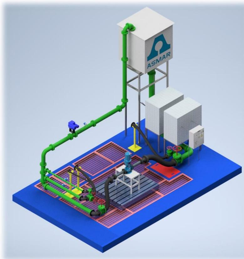
**Figura 4.12** Bomba vertical en Modelo propuesto N°2 (Fuente: Modelación propia. Renderizado Autodesk Inventor).
