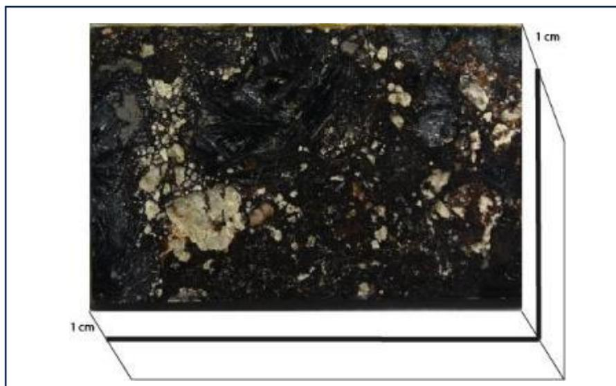
**Figura 4.1: Esquema explicativo de cómo se realizaron los cortes transparentes pulidos a partir de las briquetas.**
