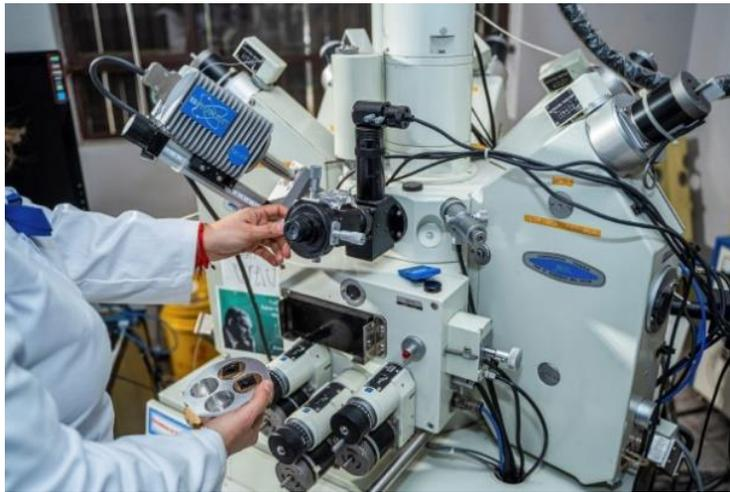
**Figura 2.4: Microsonda electrónica.** Extraído del sitio web GEA. (<https://www.institutogea.cl/portfolio/laboratorio-microsonda-electronica/>).
