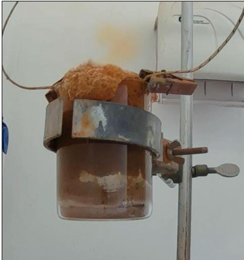
**Figura 7.1:** Ensayo de reactividad muestra 510-410. Se evidencia la ocurrencia de reacciones químicas y el desborde del vaso de precipitados.
