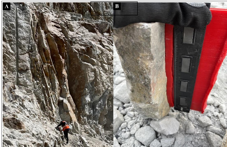
Figura 20. A. Medición de JRC en la pared. B. Medición de JRC en una muestra de la discontinuidad.
