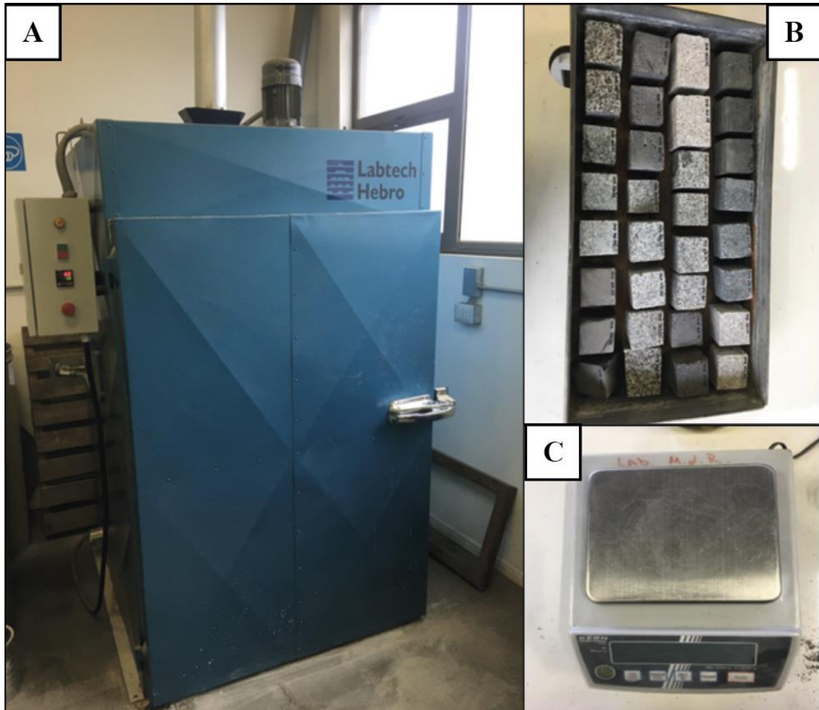
Fotografía 4.3. Herramientas utilizadas para el secado de las muestras y su pesaje. A) Horno de secado. B) Probetas campaña de invierno. C) Balanza electrónica.
