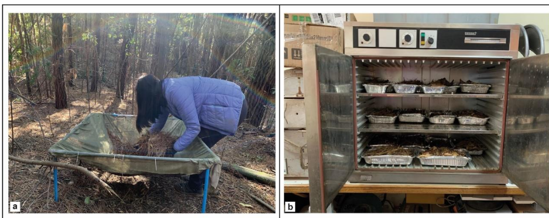
Figura 4.5 Metodología de muestreo de hojarasca de suelo. (a. Muestreo de hojarasca en terreno; b. Muestras en el horno de secado).
