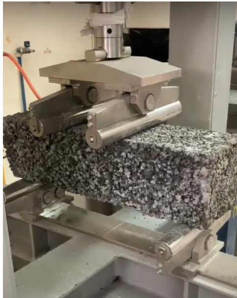
Figura 3.8 Ensayo resistencia a flexotracción
