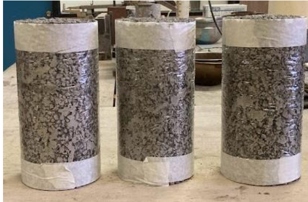
Figura 3.10 Acondicionamiento de probetas para ensayo de permeabilidad
