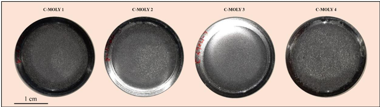
**Figura 3.5.** Montaje de muestras para análisis mediante FRX.
