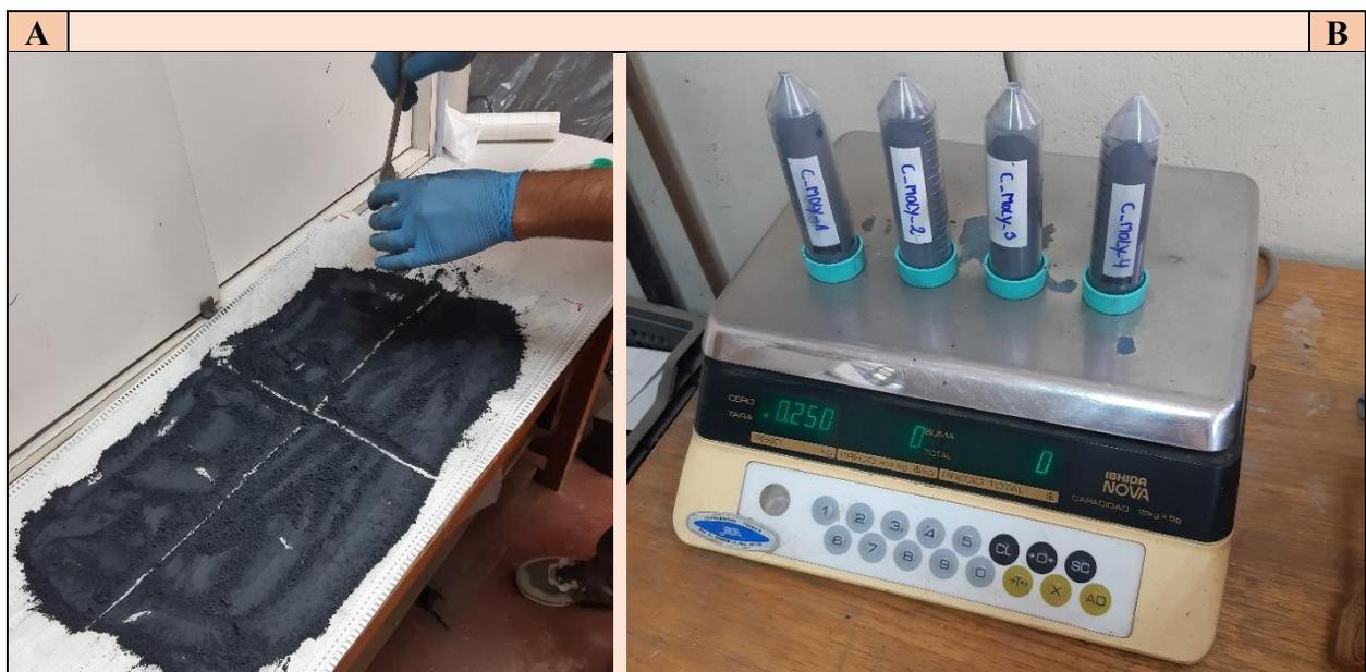
**Figura 3.1.** A) Cuarteo de la muestra. B) Muestras pesadas y envasadas.
