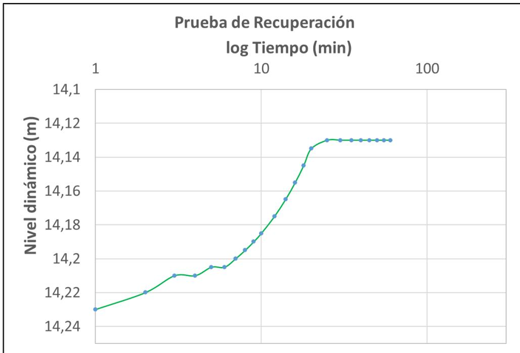
**Figura 11.** Ascenso del nivel dinámico [m] respecto al tiempo [min] en la prueba de recuperación previo al sellado.
