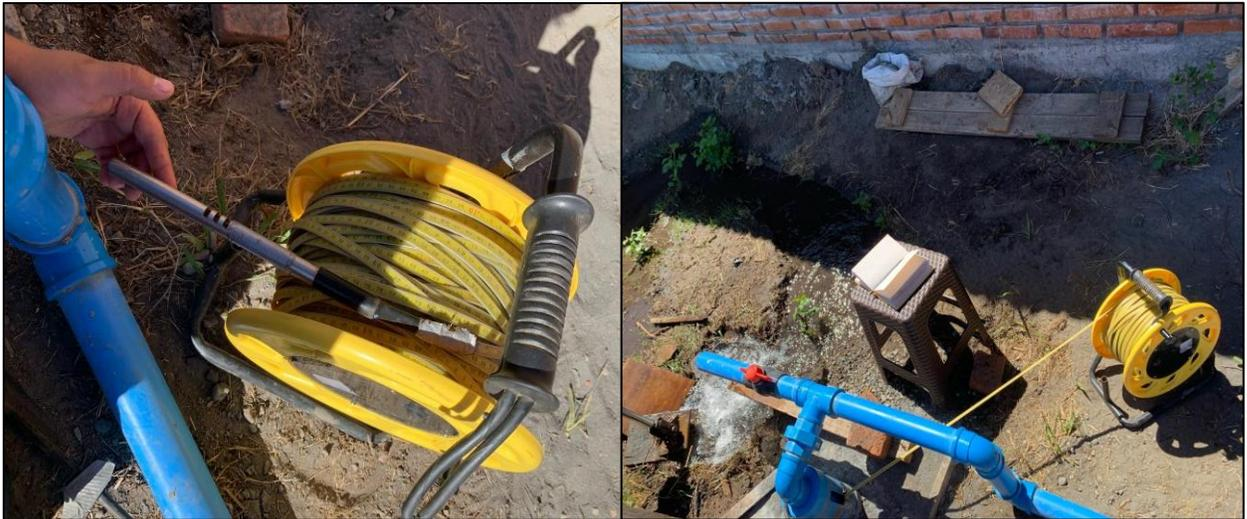
Figura 7. Piezómetro utilizado en las pruebas de bombeo y recuperación.
