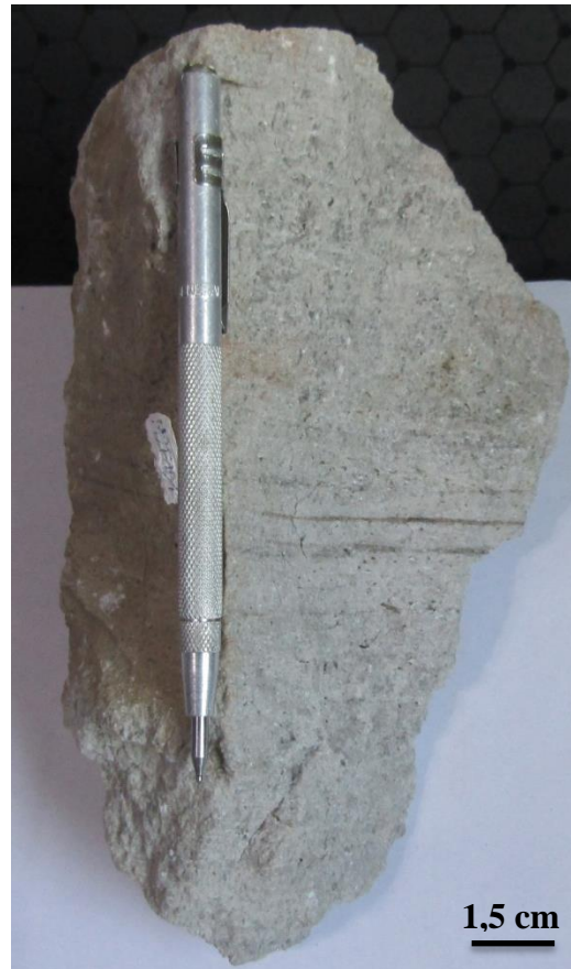
Figura 4.14: Muestra M2P1D1. Se aprecia el bandeamiento de flujo en tonalidades rosáceas y los fenocristales de biotita.
