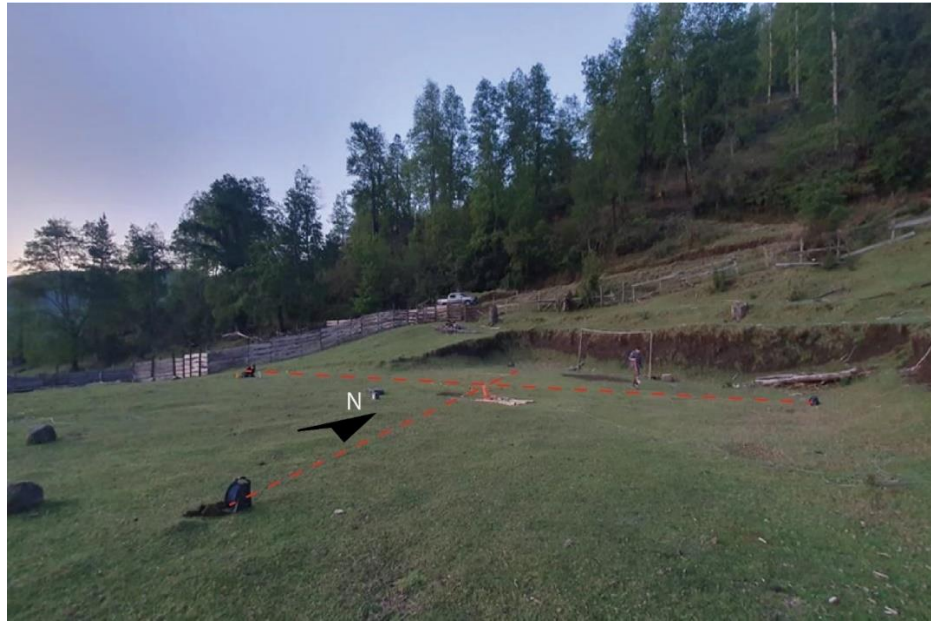
Figura 4.3 Equipo e instalación para mediciones MT. a) Equipo ADU-08. b) Preparación de bentonita para la colocación de los electrodos. c) Instalación de dipolos eléctricos ortogonales entre sí y en sentido N-S y E-W.
