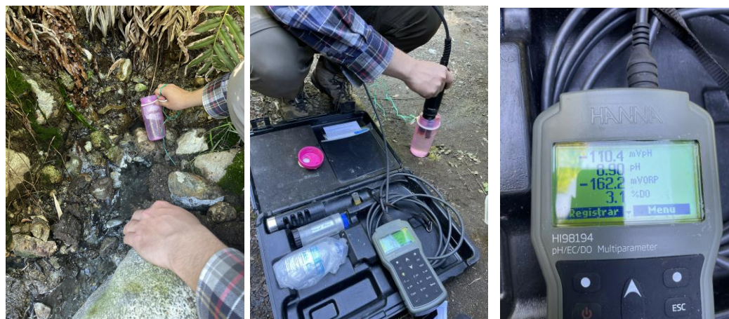
Figura 4.2 Proceso de medición de parámetros fisicoquímicos de agua termal con equipo multiparámetro HANNA HI98194
