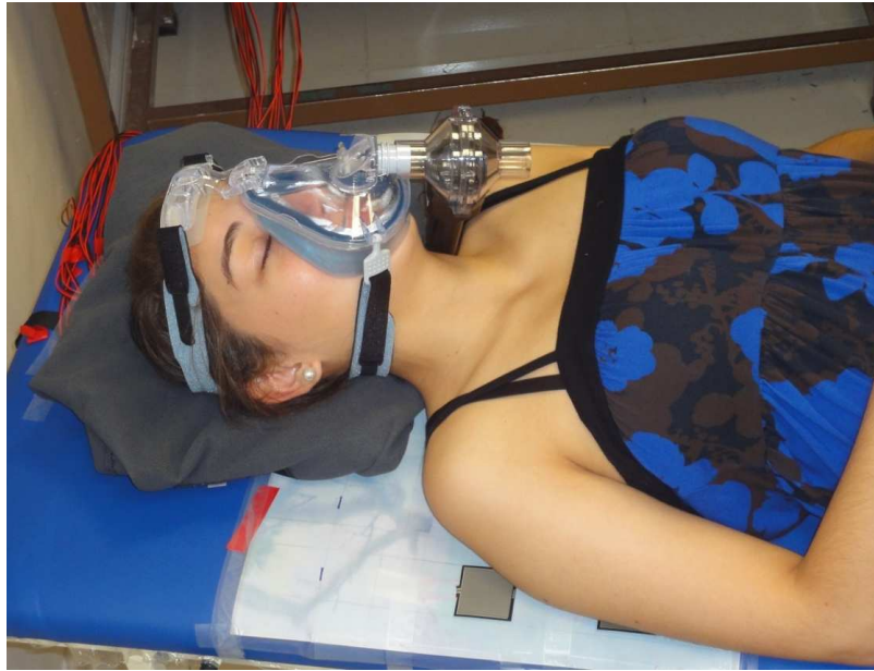
Figura 5.2: Sujeto de prueba en posición decúbito supino sobre la malla de sensores de presión y con el sensor de flujo respiratorio conectado.
