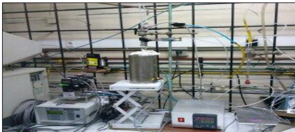
Figura n°9: Sistema de reacción catalítica montado.
