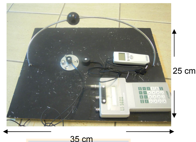
Figura 3. Método empleado para determinar valores de PAR difusa.
