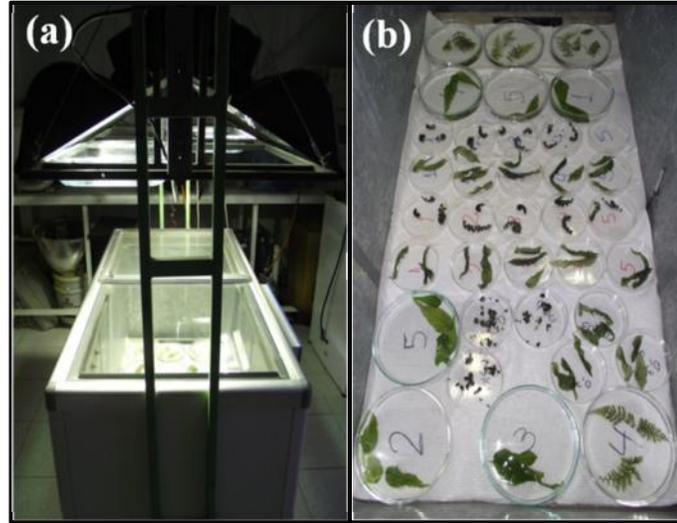
**Figura 14.** Cámara con control térmico y focos halógenos adosados a la parte superior **(a)** y frondes bajo tratamiento al interior de la cámara de fotoinhibición **(b)**.
