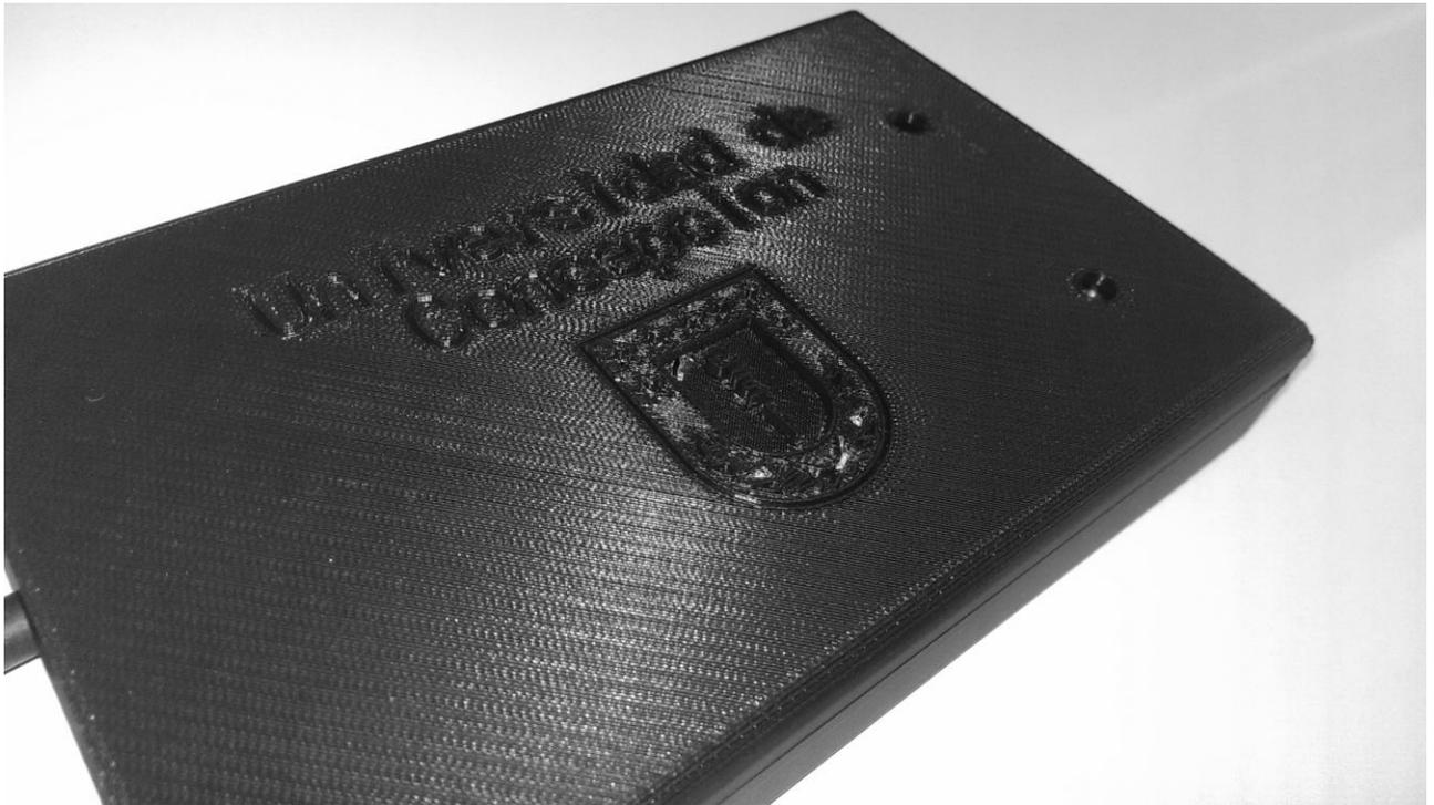
Ilustración 3.4 - Fotografía final de la carcasa impresa
