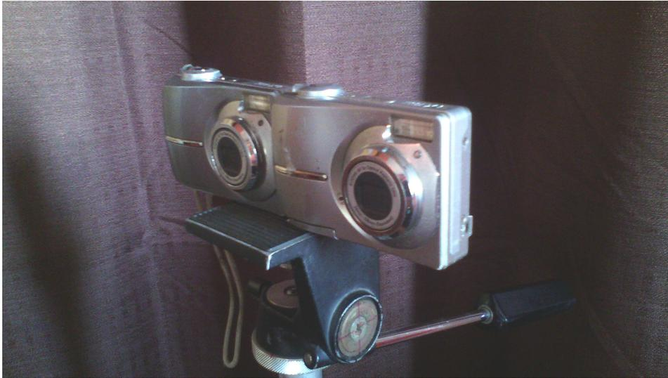
**Fig. A.3 Sistema de captura estéreo. Cámaras pegadas.**
