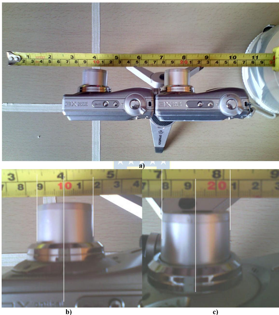
**Fig. 3.9** Comparación de la traslación horizontal de las cámaras con la obtenida en la calibración. a) Medición, b) Proyección centro óptico cámara izquierda, c) Proyección centro óptico cámara derecha.
