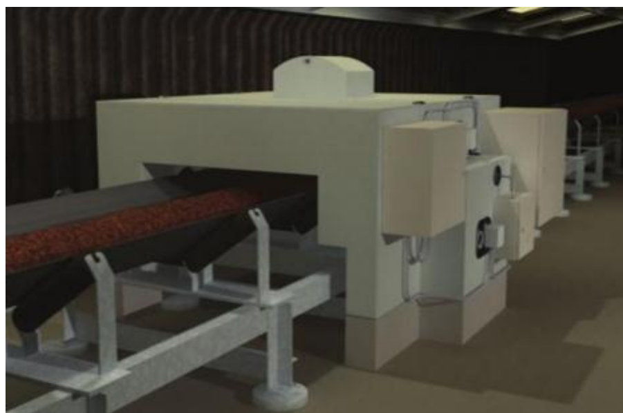
Figura 2.2-8: Analizador en línea de mineral
