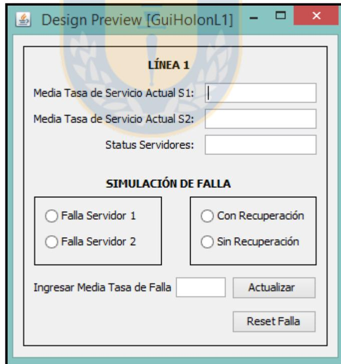
Figura 25: Layout del GUI diseñado para el Holón de Línea
