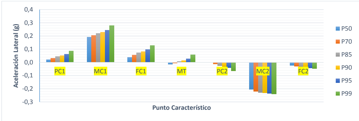
Figura A.5.3 Percentiles de aceleración para radios de entrada, salida y tangente intermedia menores a 200 m y velocidad de aproximación entre 80 y 90 km/h
