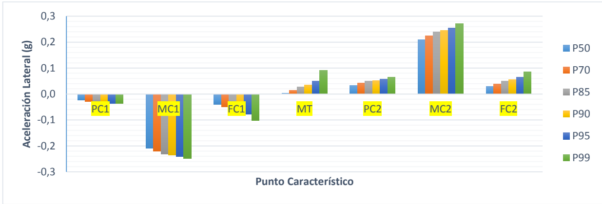
Figura A.5.12 Percentiles de aceleración para radio de entrada y salida entre 200 y 400 m, tangente intermedia menor a 200 m y velocidad de aproximación entre 100 y 110 km/h
