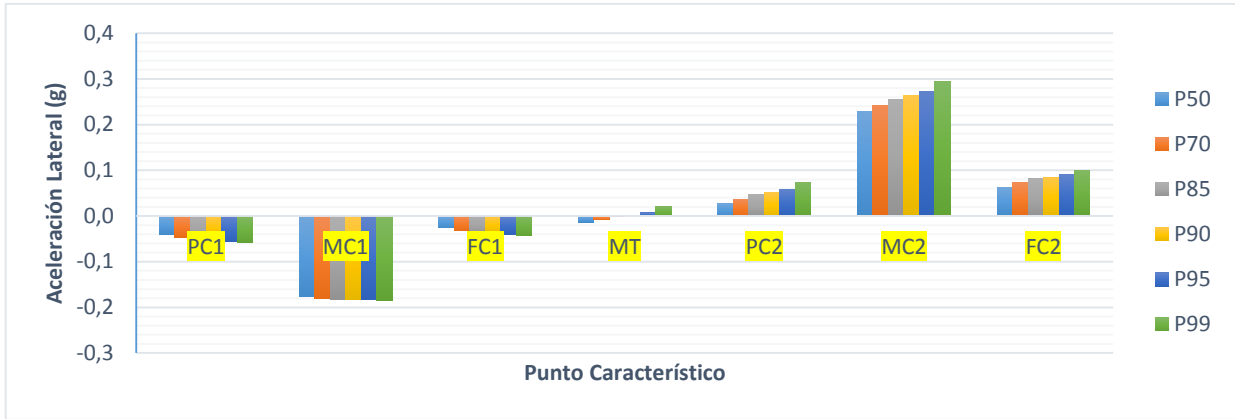
Figura A.5.30 Percentiles de aceleración para radio de entrada y tangente intermedia mayor a 400 m, radio de salida entre 200 y 400 m y velocidad de aproximación entre 90 y 100 km/h
