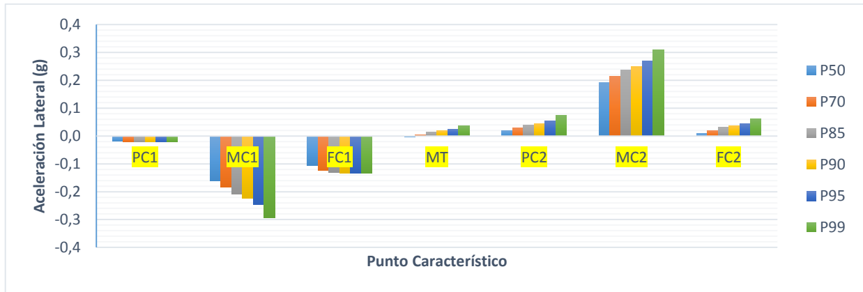
Figura A.5.15 Percentiles de aceleración para radio de entrada y tangente intermedia entre 200 y 400 m, radio de salida menor a 200 m y velocidad de aproximación entre 80 y 90 km/h
