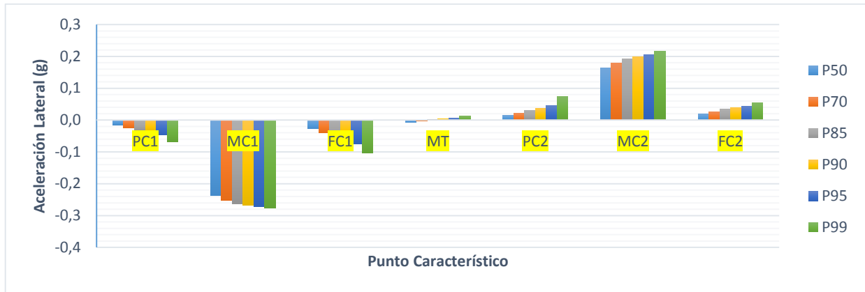
Figura A.5.24 Percentiles de aceleración para radio de entrada entre 200 y 400 m, tangente intermedia y radio de salida mayor a 400 m y velocidad de aproximación entre 80 y 90 km/h
