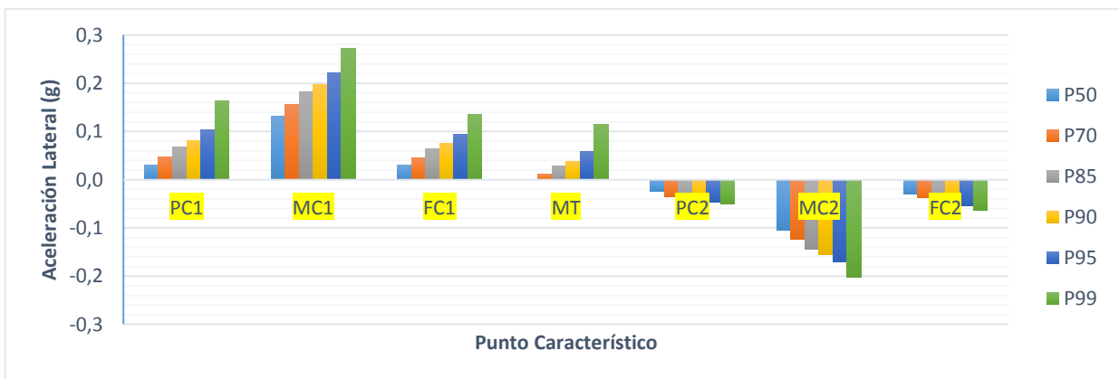
Figura A.5.35 Percentiles de aceleración para radio de entrada, radio de salida, tangente intermedia mayor a 400 m y velocidad de aproximación entre 100 y 110 km/h
