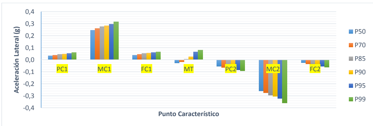
Figura A.5.5 Percentiles de aceleración para radios de entrada, salida y tangente intermedia menores a 200 m y velocidad de aproximación entre 100 y 110 km/h
