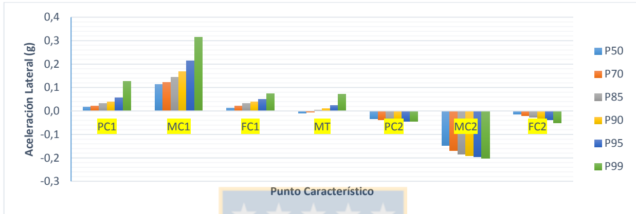
Figura A.5.1 Percentiles de aceleración para radios de entrada, salida y tangente intermedia menores a 200 m y velocidad de aproximación menor a 70 km/h
