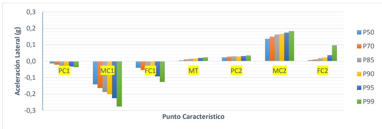
Figura A.5.26 Percentiles de aceleración para radio de entrada y salida mayor a 400 m, tangente intermedia menor a 200 m y velocidad de aproximación entre 90 y 100 km/h
