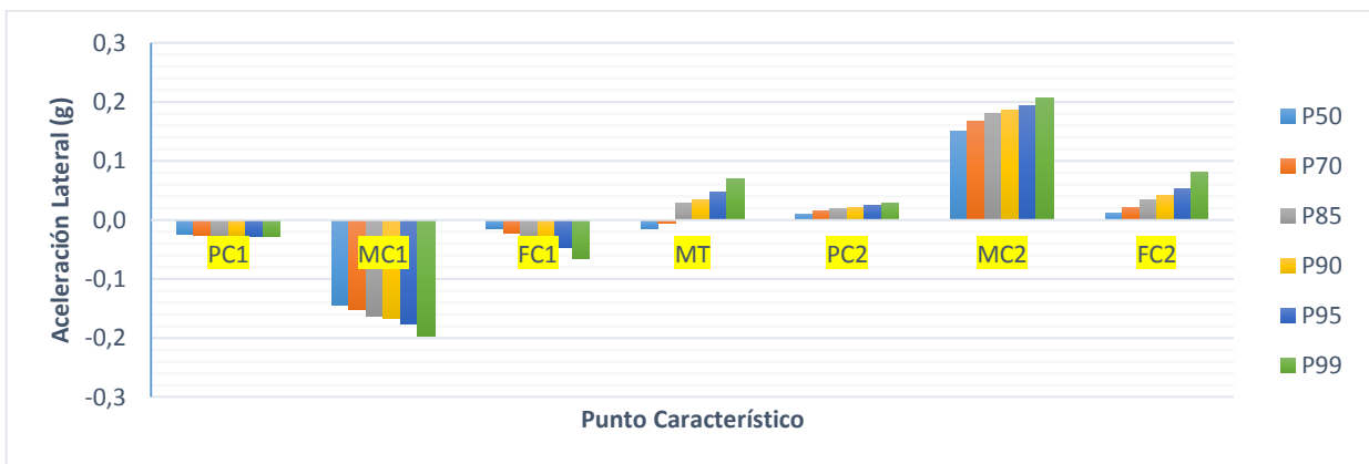
Figura A.5.14 Percentiles de aceleración para radio de entrada y tangente intermedia entre 200 y 400 m, radio de salida menor a 200 m y velocidad de aproximación entre 70 y 80 km/h
