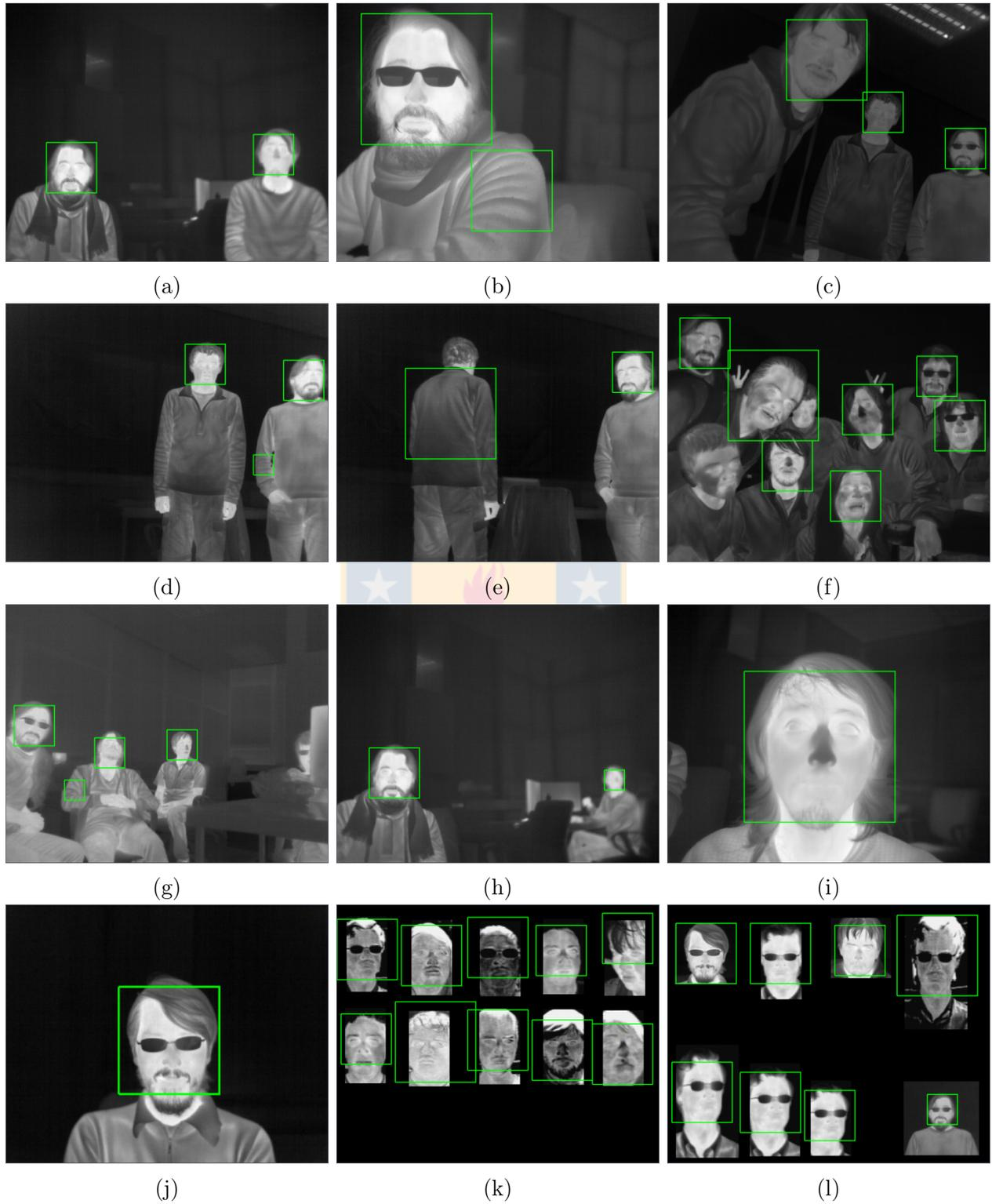
Figura 5.6: Salida del detector para 12 imágenes diferentes, nueve obtenidas por la cámara infrarroja, una correspondiente a la base de datos LWIR UdeC, y dos generadas de forma artificial para contener rostros de la base de datos UCHThermalFace y de distintas bases de datos. Se pueden ver falsos positivos generados por el clasificador en distintas regiones.
