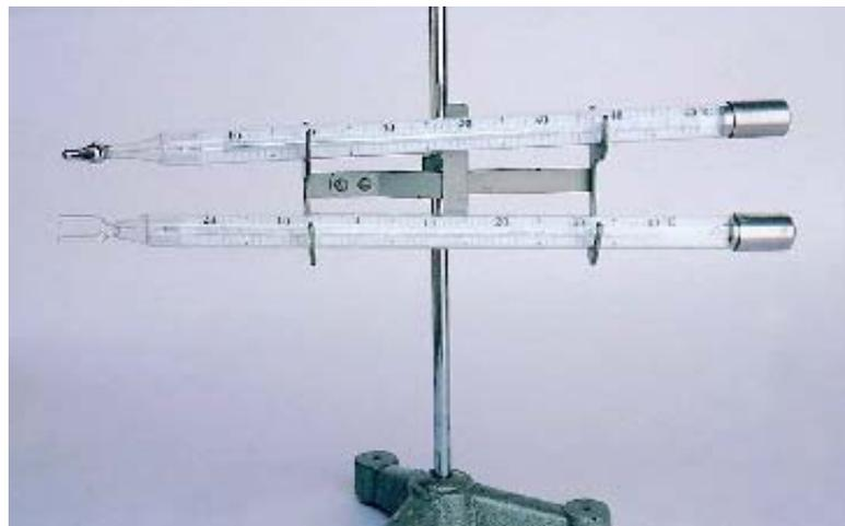
Figura 12.1 Termómetros de máxima y de mínima usados en meteorología.
