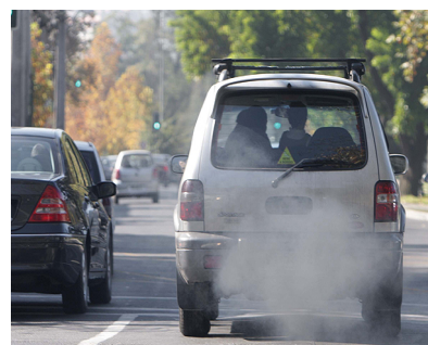
(b) Vehículo con problemas de emisión de gases.
