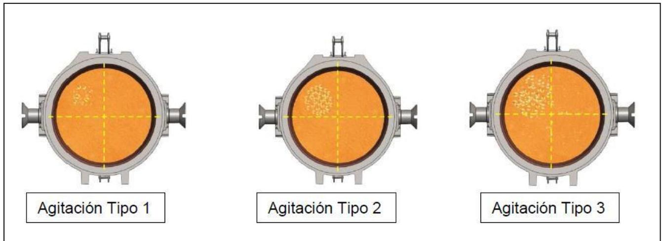
Figura 41: Agitación con Argón con un poroso operando<sup>42</sup>
