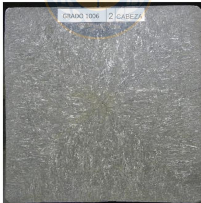
*Figura 46: Macrografía de muestra Cabeza, correspondientes a la línea 2 de la Colada Continua.*
