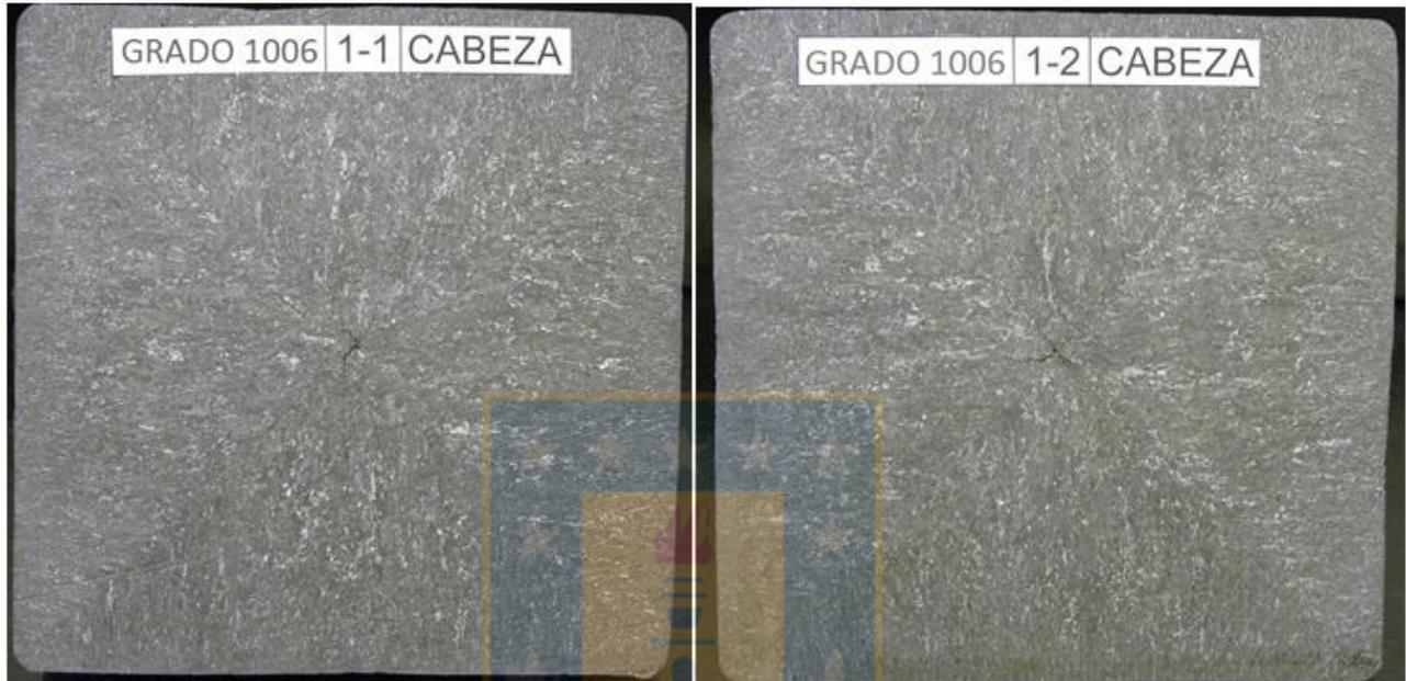
*Figura 42: Macrografías de palanquillas 1 y 2 grado 1006. Muestra Cabeza.*
