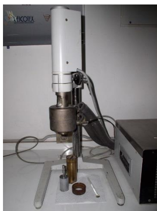
Figura 16: viscosímetro Haake Modelo RV 20 Rotovisco
