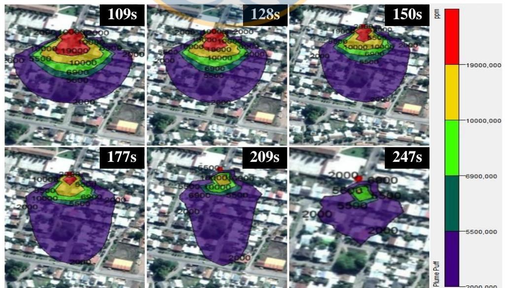
4.4 Modelación 4, Fuga de estanque con capacidad volumétrica de 2 m<sup>3</sup>, condición atmosférica estable en verano y dirección del viento 200°. Ubicación en UTM 18H0704986/5847348.
