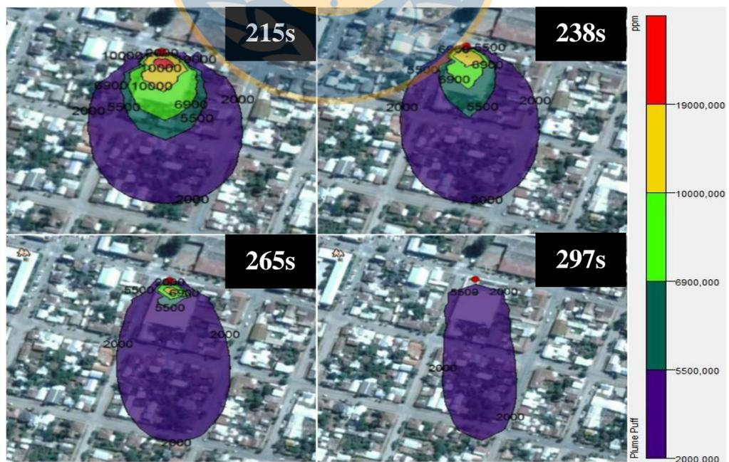
Figura 8. Dispersión de GLP desde una fuga ocurrida en 180 segundos para un estanque de 2 m<sup>3</sup> en una condición estable de invierno.
