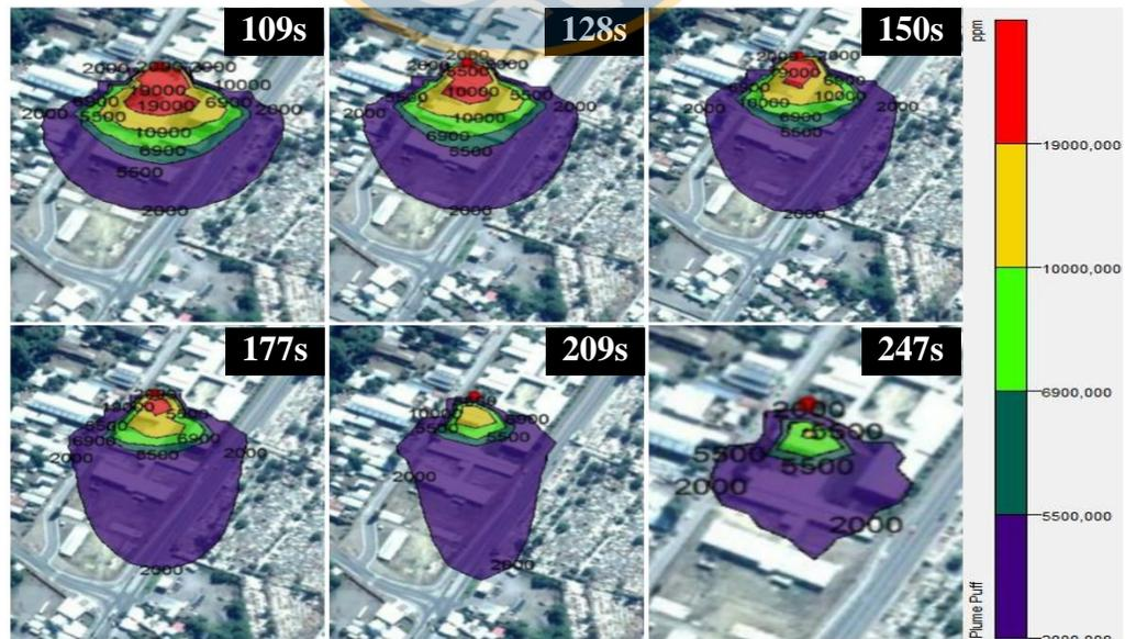
2.12 Modelación 12, Fuga de estanque con capacidad volumétrica de  $2 \text{ m}^3$ , condición atmosférica estable en verano y dirección del viento  $200^\circ$ . Ubicación en UTM 18H0702880/5873230.
