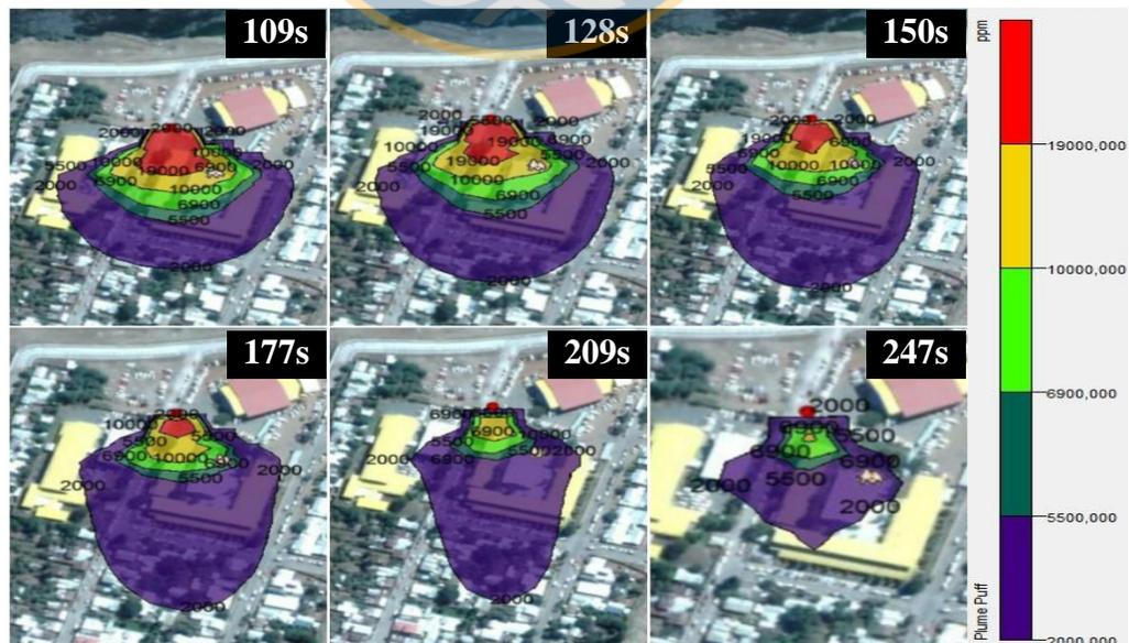
3.20 Modelación 20, Fuga de estanque con capacidad volumétrica de  $2 \text{ m}^3$ , condición atmosférica estable en verano y dirección del viento  $200^\circ$ . Ubicación en UTM 18H0743272/5822657.
