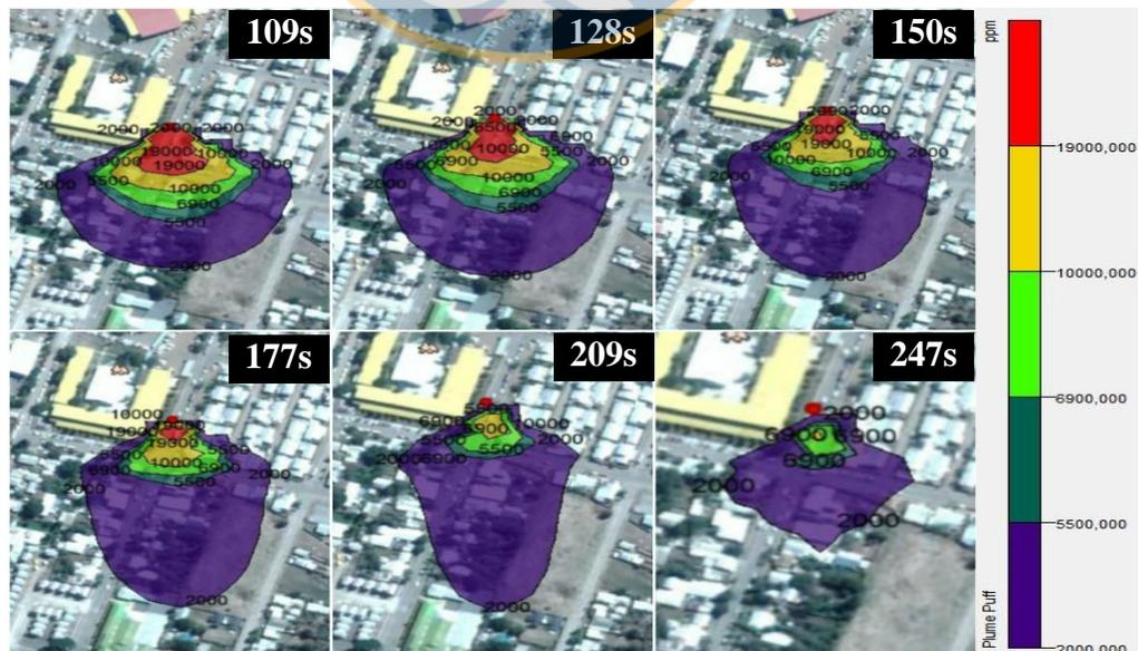
3.18 Modelación 18, Fuga de estanque con capacidad volumétrica de 2 m<sup>3</sup>, condición atmosférica estable en verano y dirección del viento 200°. Ubicación en UTM 18H0743334/5822559.
