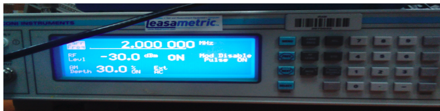
Figura 4.1: Generador de señales Marconi.
