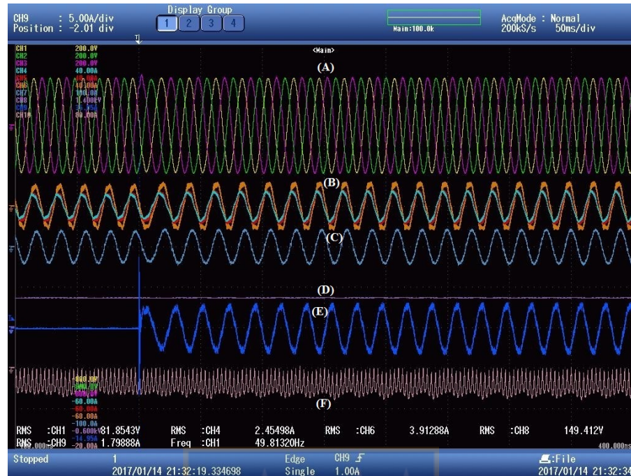
Figura 5.22: Impacto de un capacitor en el PCC. (A) Tensiones de línea. (B) Corrientes fase A de los inversores 1-2-3. (C) Corriente fase A del rectificador de 18 pulsos. (D) Tensión del enlace DC. (E) Corriente Fase A del capacitor. (F) Corriente DC del convertor AC/DC [Fuente: elaboración propia].
