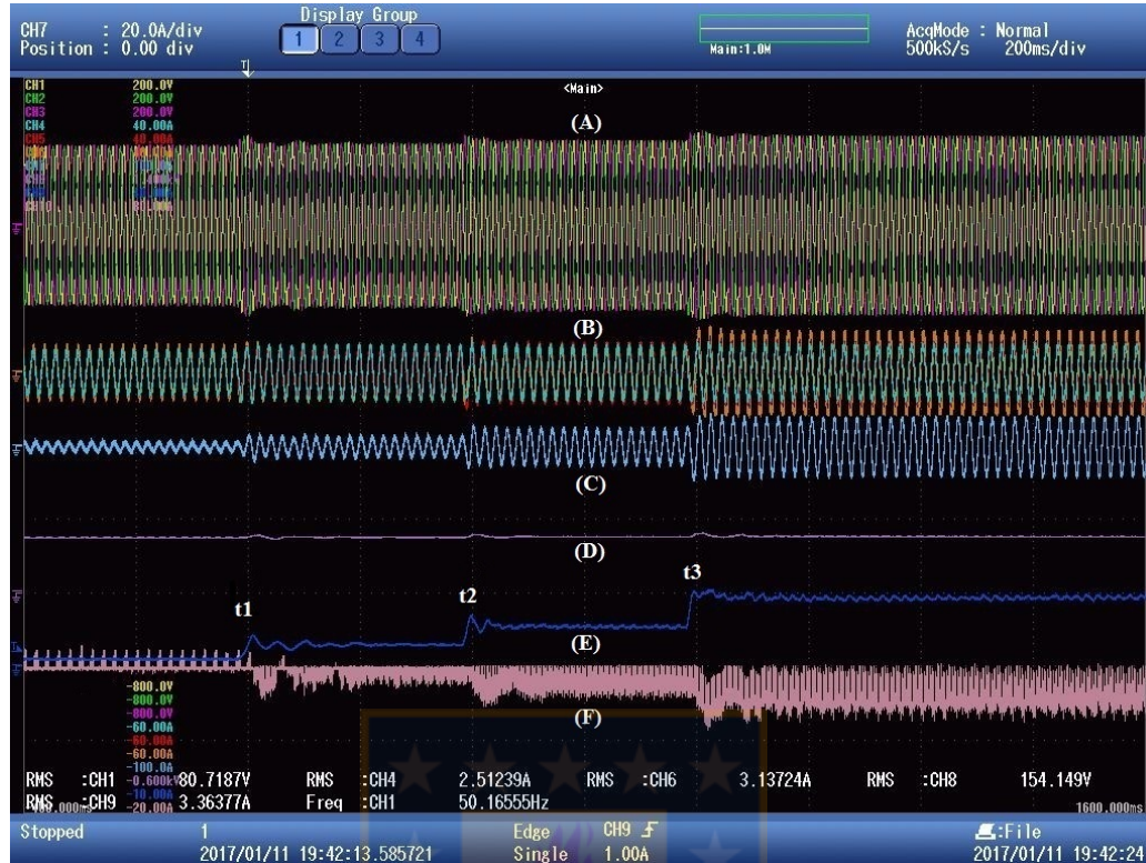
Figura 5.24: Cambios en las referencias de potencia de los inversores. (A) Tensiones de línea. (B) Corrientes fase A de los inversores 1-2-3. (C) Corriente fase A del rectificador de 18 pulsos. (D) Tensión del enlace DC. (E) Corriente DC en la salida del rectificador de 18 pulsos. (F) Corriente DC del convertor AC/DC [Fuente: elaboración propia].
