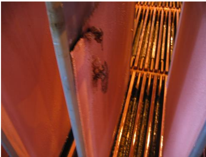
Figura 2.2 Cátodo con cortocircuito metalúrgico (COCI). Fuente: Elaboración propia.
