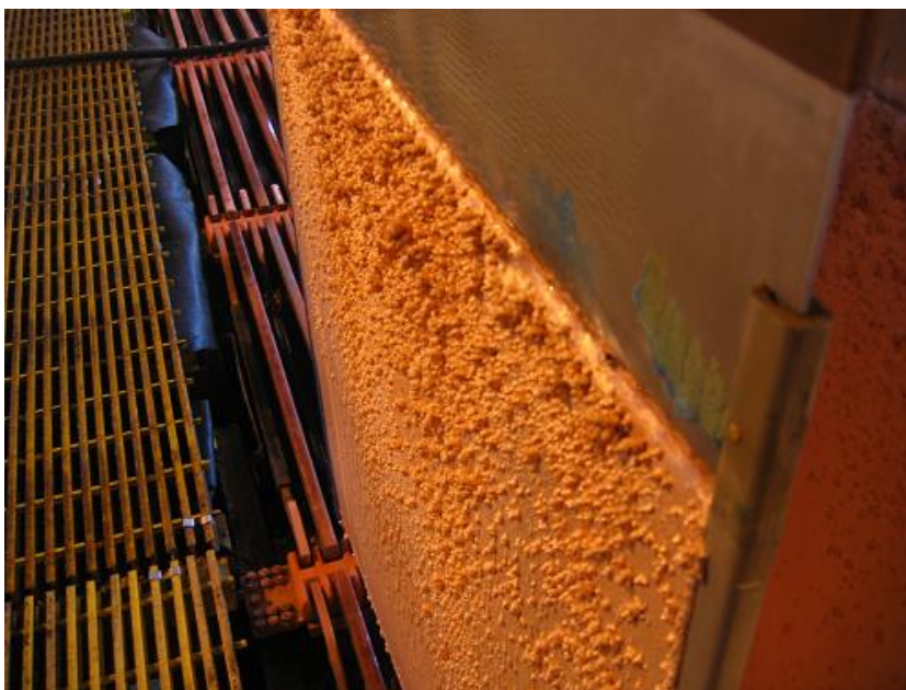
Figura 2.4 Cátodo con Nodulación excesiva debido a CIAB vecino. Fuente: Elaboración propia.
