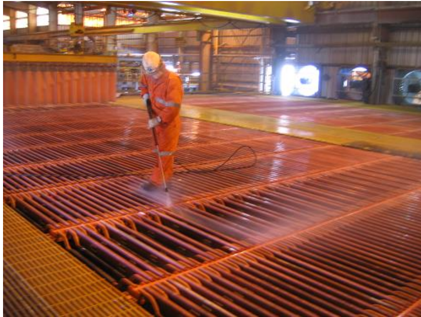
Figura 5.2 Limpieza de contacto realizada con hidrolavadora. Fuente: Elaboración propia.
