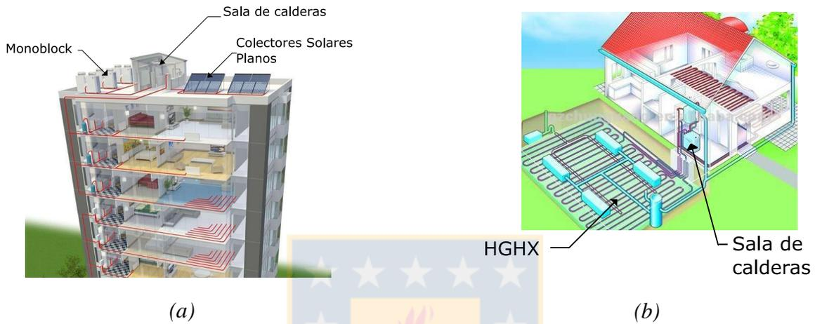
**Figura 19:** (a) Integración de sistema SHP en un edificio de departamentos (Fuente: Elaboración Propia) (b) Integración de bomba de calor geotérmica en una casa. (Design One Mechanical, 2014)
